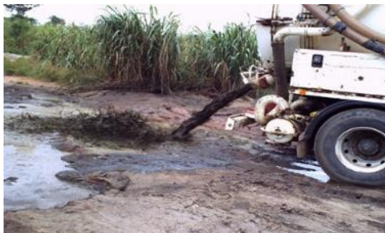
Photo 1.4 : Véhicule de vidange déversant des boues sur la décharge d'Atidjin
